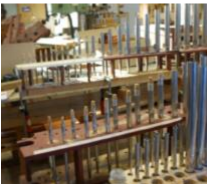
Rohrflöte 4 Fuss , fra fs'' forsynet med skruegevind og korkpropper.
