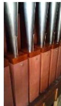
Posaune 16'. Skruer på støvler sikrer fast position for rørstemmehoved.
