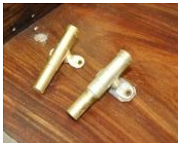
Der manglede lyseholder i den ene side af klaviaturet. Kopi tilvirket af messing.
