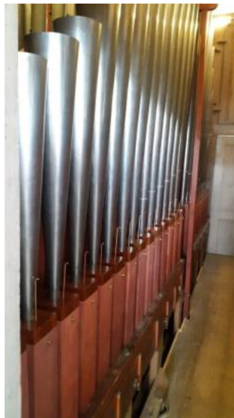
Posaune 16'. Skruer på støvler sikrer fast position for rørstemmehoved.
