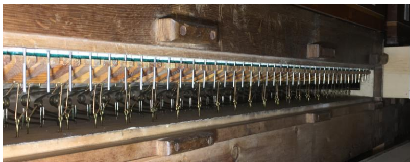
Ventiler i manualvindlade.
