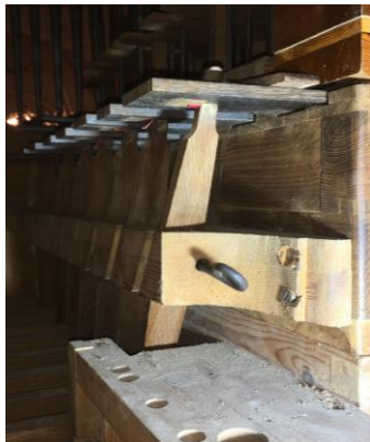
Træsværd forbundet med sløjfer på manualvindlade.
