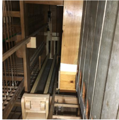
Bælgens trædemekanik og calcantklokke.
