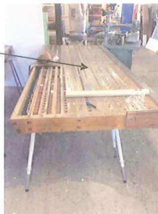
Papir/tape fjernes fra fundament på 4 vindlader
