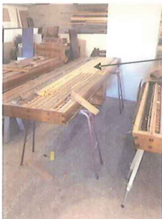
Papir/tape fjernes fra fundament på 4 vindlader
