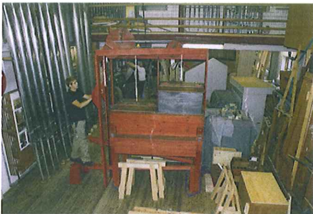
Det restaurerede/rekonstruerede kassebælgeanlæg i afprøves af Søren i orgelsalen.
