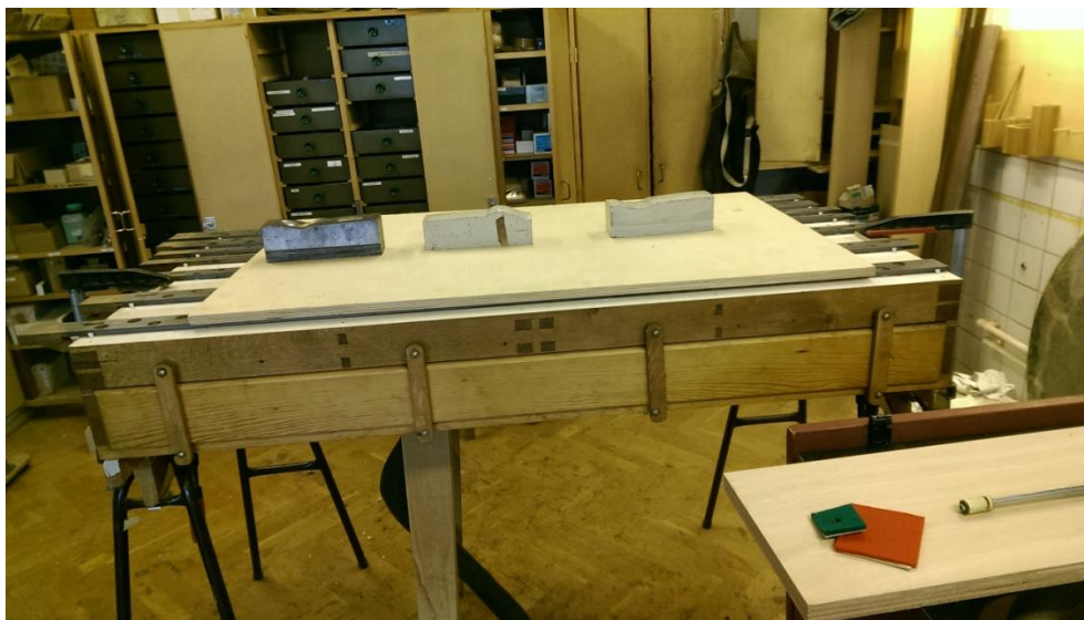
Vindladen under renoveringen på værkstedet
