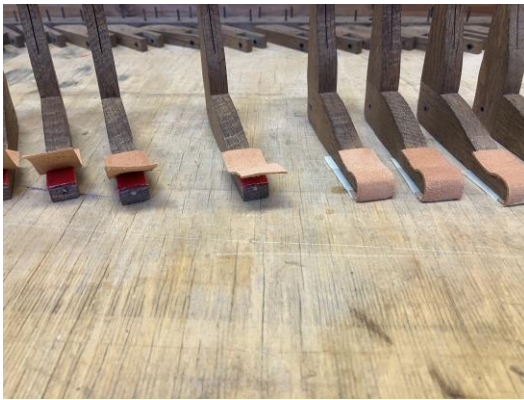
Istandsættelse af lejer og pedalvinkler, foring på pedal trakturvinkler.
