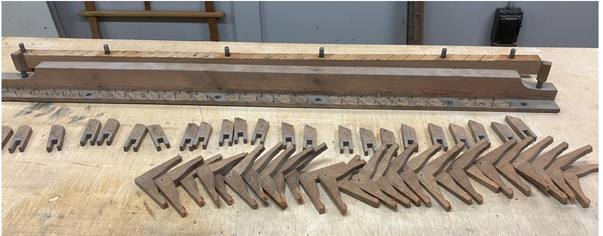
Istandsættelse af lejer og pedalvinkler, foring på pedal trakturvinkler.
