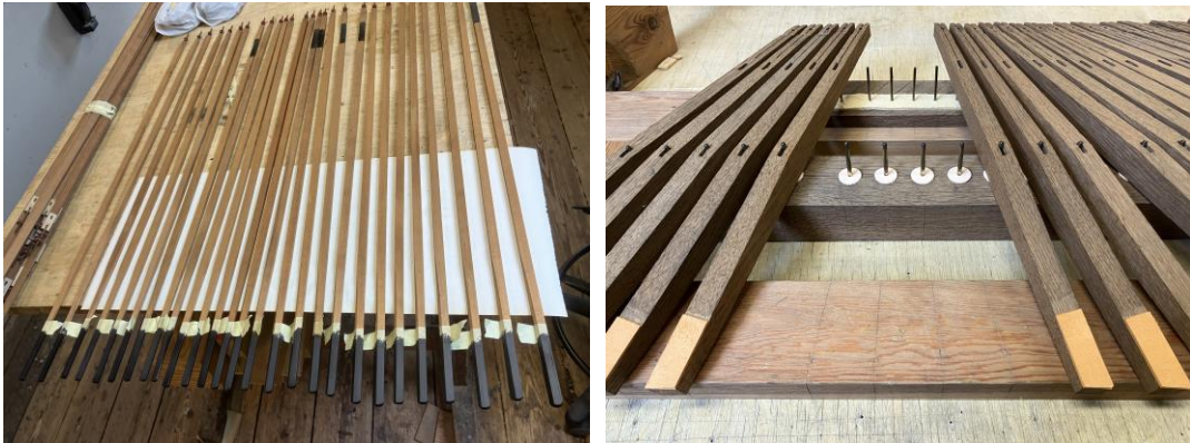
Pedalstikkere, til kobling til manual, grafitteret. Kobbelvipper istandsat med skind.
