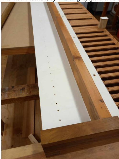
Manualvindlade, afrensning af gammel skindbelægning
