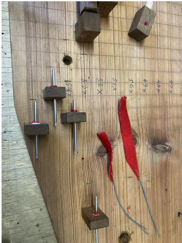
Istandsættelse af velleramme kapsler/lejer
