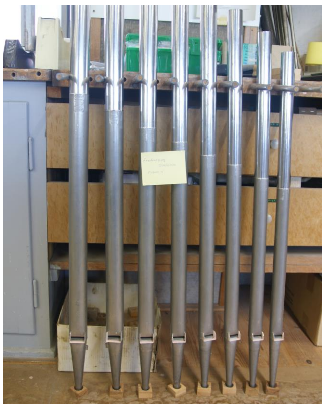
Fugara 4', forlænget, forsynet med pibeskæg
