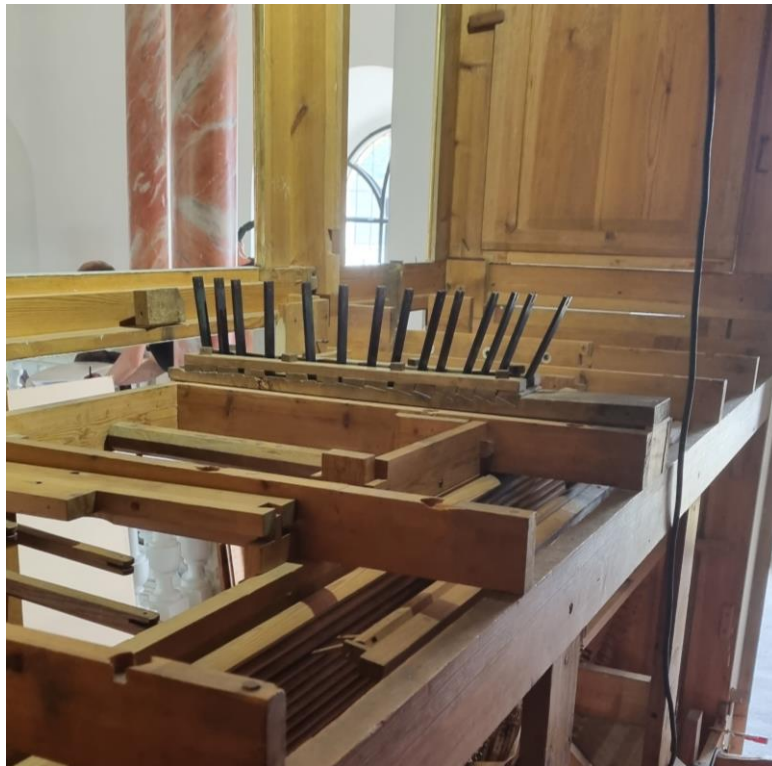
Registersværd er anbragt mellem C- og Cis manualvindlade
