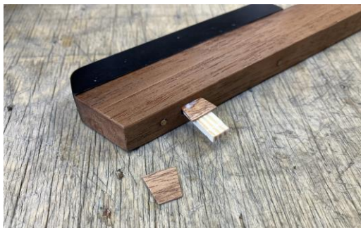
Manuالتangent styreslids, nyt træ limet i
