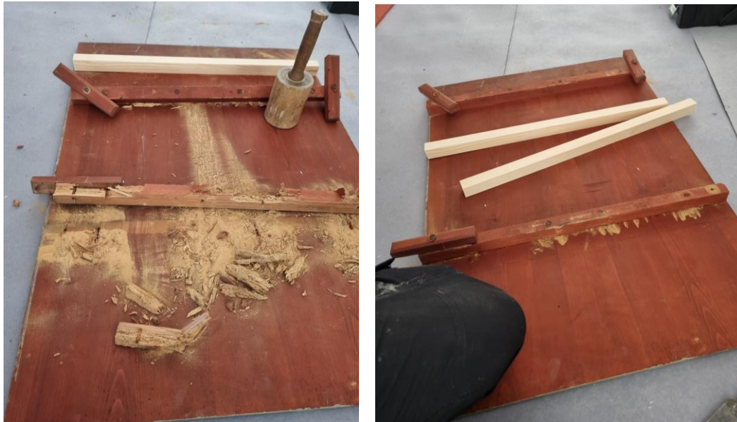
Istandsættelse af låger, som er anbragt foran vellerammer inden i orglet.
