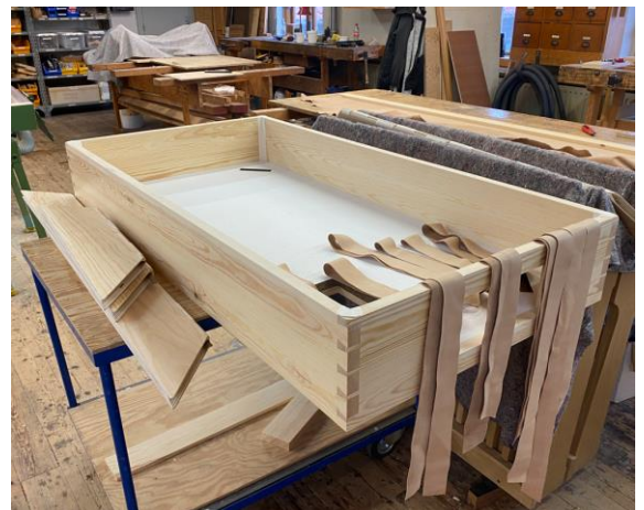
Ny bælg til Overværk, under fremstilling på orgelbyggeriet
