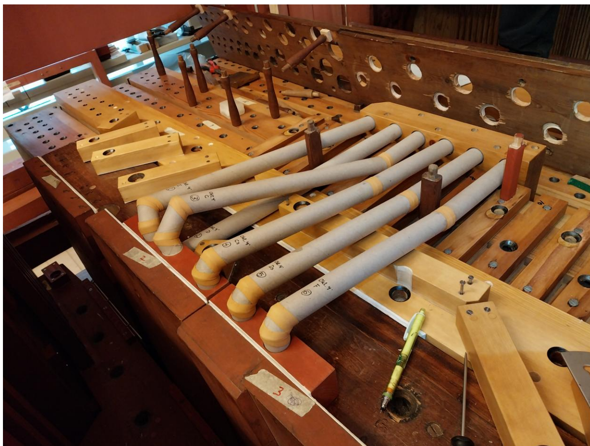
Midt i billedet, delvis skjult under pap-konduktorer og nye forføringssklodser af fyr, ses den nye pibestok til Bordun 16 F
