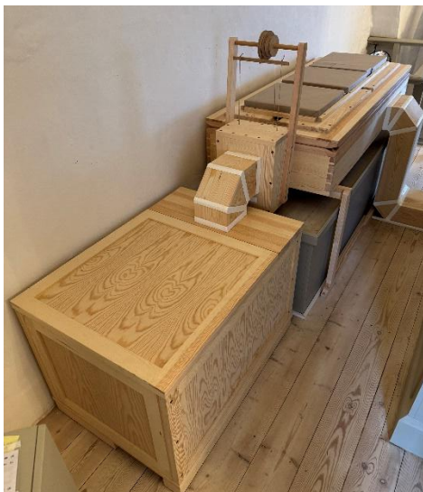
Det nye vindsystem, med blæserkasse, rulleventil, faltebælg og tilslutningskanal.
