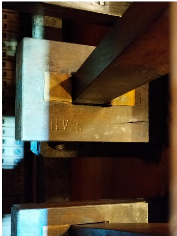
Gamle træsløjfer, poleret med grafit. Sløjfestop, tilpasset/repareret.
