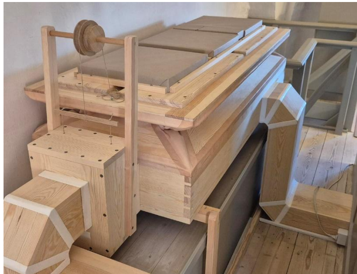
Det nye vindsystem, med blæserkasse, rulleventil, faltebælg og tilslutningskanal.
